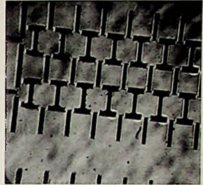
Een bekleding van I-vormige staafjes (sterk vergroot), voor de geleiding van bubbles met hoge snelheid. Vier bubbles zijn als witte gebiedjes te zien aan de uiteinden van de staafjes (overgenomen van Plessey Company Ltd).
